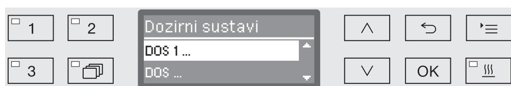
Broj dozirnih sustava može varirati ovisno o opremi i priključenim DOS-modulima.
