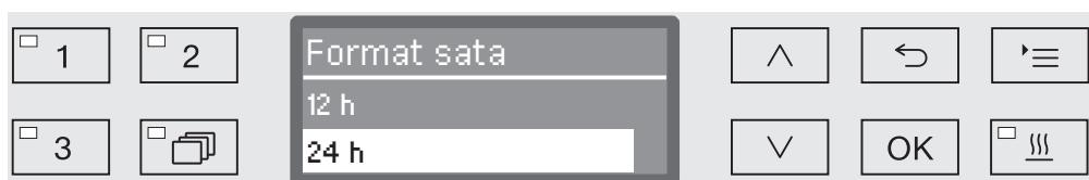
■ Odaberite željeni format dnevnog vremena pritiscima na tipke sa strelicama ^ i v i pohranite odabir tipkom OK.
