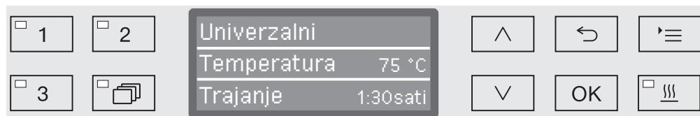
Pored zaslona prikazane su upravljačke tipke. Nisu prikazane tipke  $\odot$ ,  $\circ-$  i Start/Stop.
