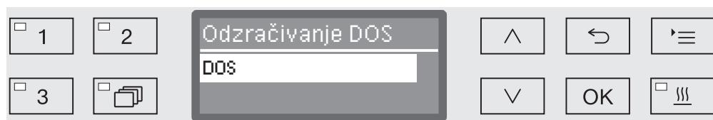
S odabirom dozirnog sustava pokreće se automatsko odzračivanje. Jednom započeti postupak automatskog odzračivanja ne može se više prekinuti.
